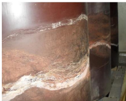
Afb. 24: Kruipsporen en sporen van deelontladingen
