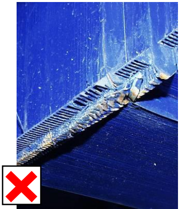
Afb. 13: Niet toegestaan! De uiteinden van de kernen van dit juk zijn erg verbogen en raken elkaar
