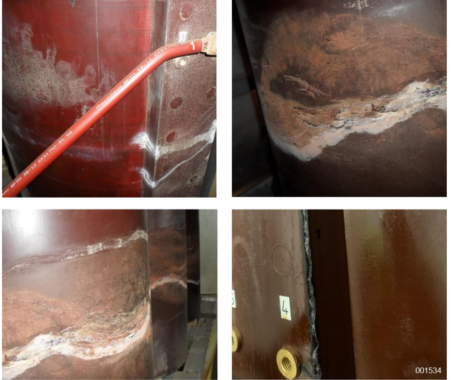
Şek. 24: Sürtünme izleri ve kısmi boşalma izleri
