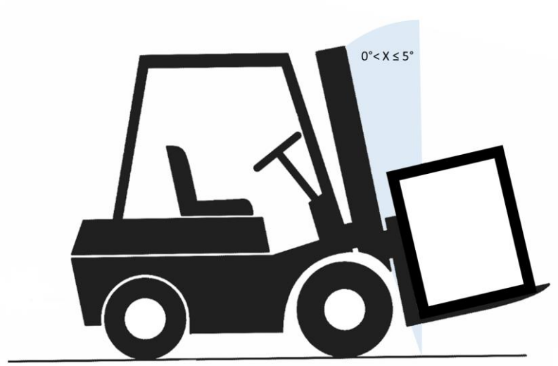
Şek. 9: Forkliftle taşıma için eğim açısı
