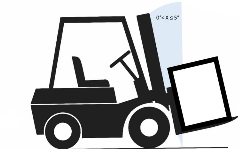
Рис. 9: Угол опрокидывания при транспортировке с помощью вилочного погрузчика
