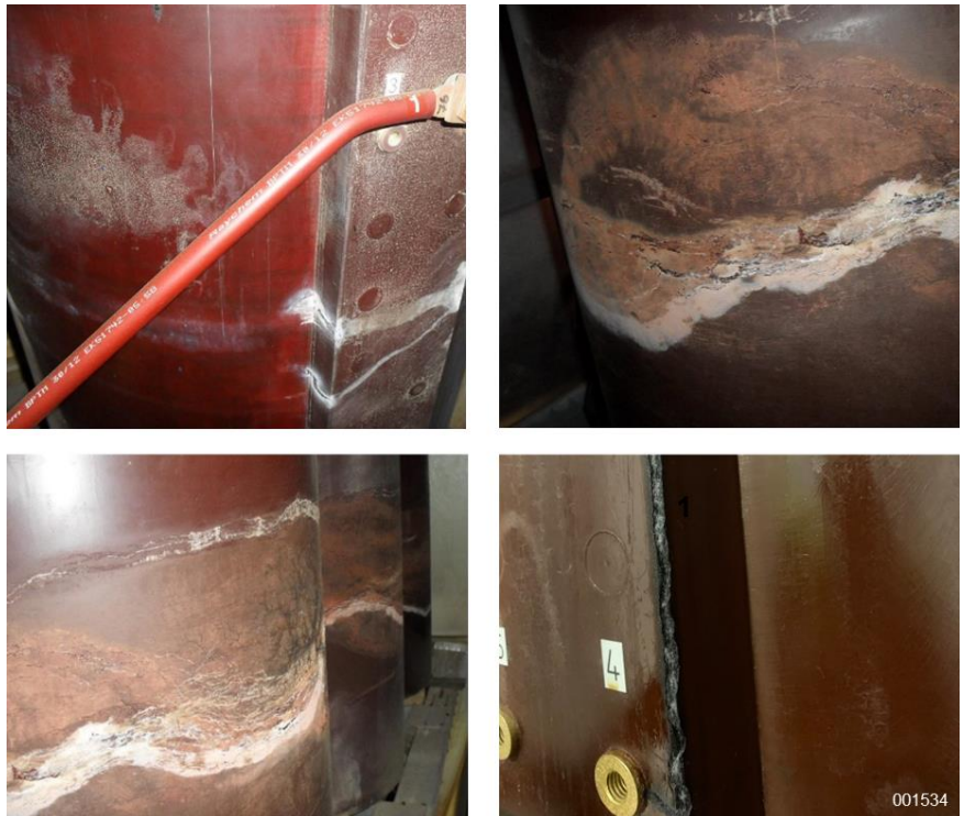
Рис. 24: Поверхностные утечки тока и частичный разряд
