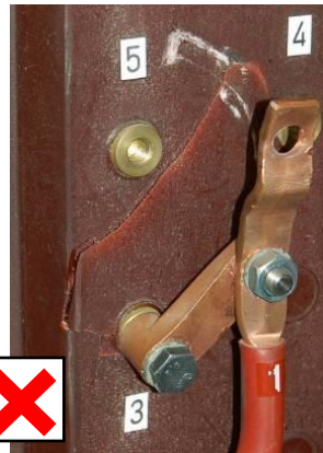
Kuva 12: Ei sallittu! Halkeillut pinta kytkenäliitoksen kohdistuneen väkivoiman vuoksi
