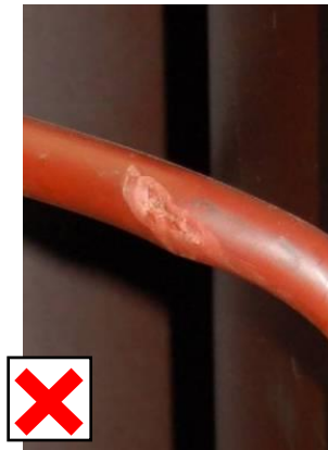
Kuva 11: Ei sallittu! Kytkenäliitoksen vääntynyt eristys
